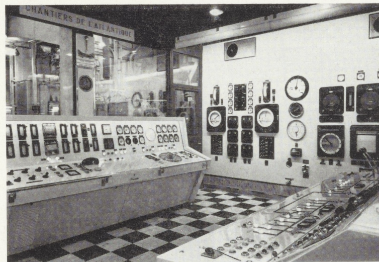
Centralisatie van de instrumenten in de machinekamer van het s.s. „Sivella”.
